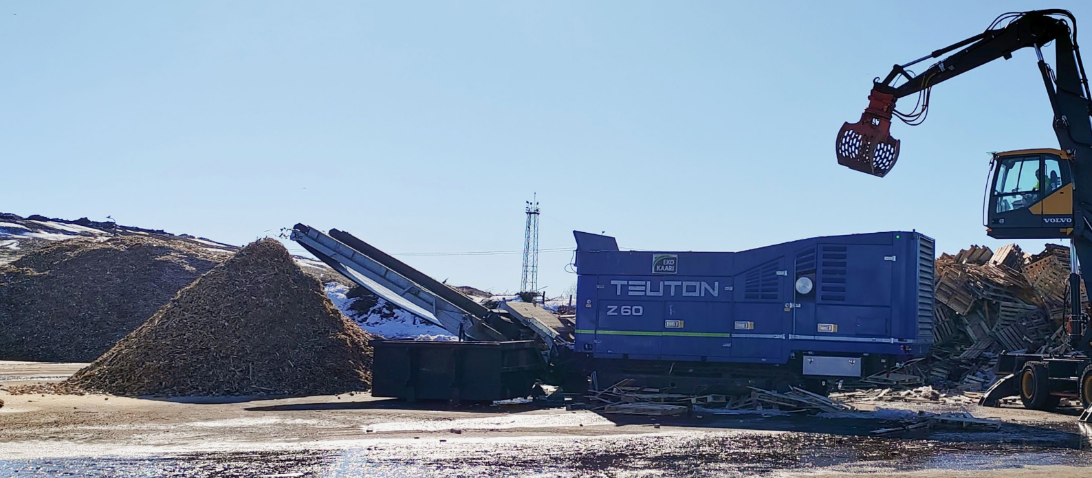
Volvo EW240E-materiaalinkäsittelijä syöttää puujätettä Teuton Z60 -mobiilimurskaimeen lajittelukentällä.
